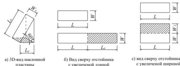
Рис. 4 Увеличенная площадь оседания отстойника и пластинчатых отстойников.
