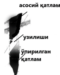
3-расм. Соф грунт қатламларнинг блоккли силжиши.
