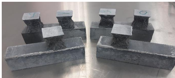
2-rasm. Sement namunalarining siqilishga bo'lgan mustahkamligini aniqlash
