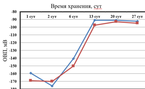
Рисунок 2. Окислительно-восстановительный потенциал воды хранения (открытый способ): - без добавки; - с добавкой 40% ЭТФ шлака.
