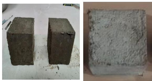
а – после формования; б – после твердения Рис. 4. Образцы арболита:
