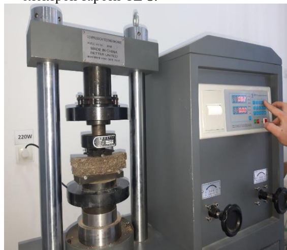
4-расм. Тажиба-синов ишлари бўйича вермикулит плитасининг эгилишга ва сиқилишга бўлган мустаҳкамлигини аниқлаш
