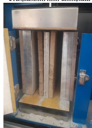
4-расм. Тажиба-синов ишлари бўйича вермикулит плитасининг эгилишга ва сиқилишга бўлган мустаҳкамлигини аниқлаш
