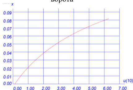
Рис. 2. Деформация центра тяжести сечения от положения мгновенного центра поворота
