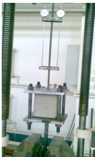
Рис.1. Общий вид установки для испытаний на выдергивание арматуры из бетонного куба.
