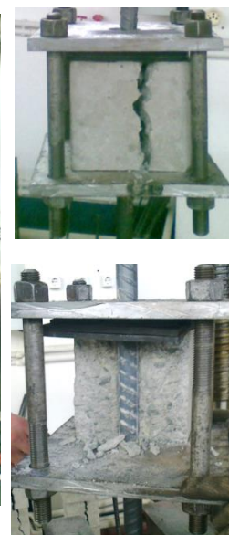
Рис.2. Характерное разрушение опытных образцов после испытаний.
