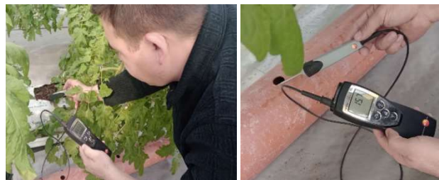
3-расм. Testo 925 тупроқ намлиги ва ҳароратини ўлчайди
