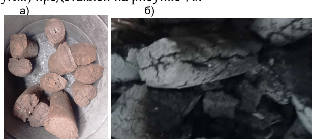
Рис. 7. – Вид исследуемого MSF -топлива, в модульной установке до и после пиролиза
