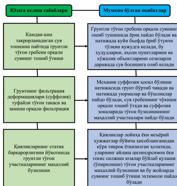
2-расм. IV синф грунтли ГТИда мумкин бўлган авария сценарийлари
