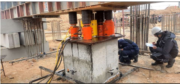
4-расм. Синаш жараёнида синалаётган қозикнинг силжишини кузатиш учун ўрнатилган индикаторлар ва улардан саноқлар олиш жараёнидан фото сурат.
