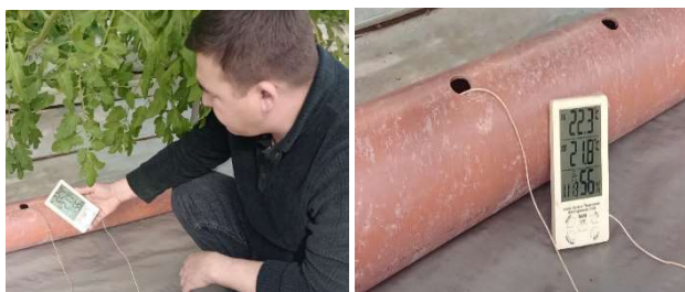
2-расм. LCD дисплейли НТС-2 электрон термометр-гигрометр.
