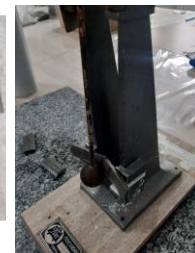
4-rasm. Bazalt sement asosida ishlab chiqarilgan tom qoplamasining yoriqqa bardoshlilikini aniqlash
