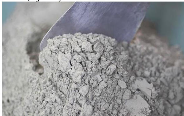
2-rasm. Korxonada ishlab chiqarilgan SEM 32,5H portlandsement Sinov tajribasining birinchi bosqichida 1-jadval asosida qorishma tayyorlandi.
