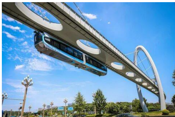
1-rasm. Monorels ustki va osilgan tizimi
