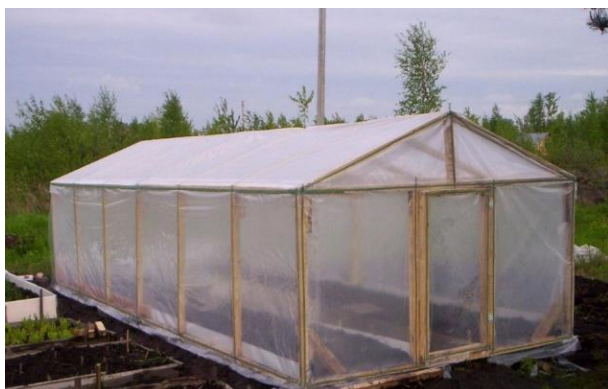
4-rasm. Shaffof plyonka bilan qoplangan yog'och konstruksiyaga ega issiqxona.
