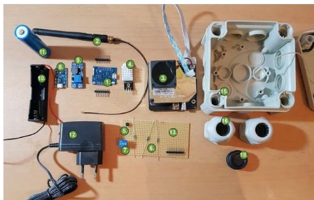
3-rasm. Qurilmaning umumiy montaj ko'rinishi hamda Sensor bloki va filtr moduli o'rnatilishi.
