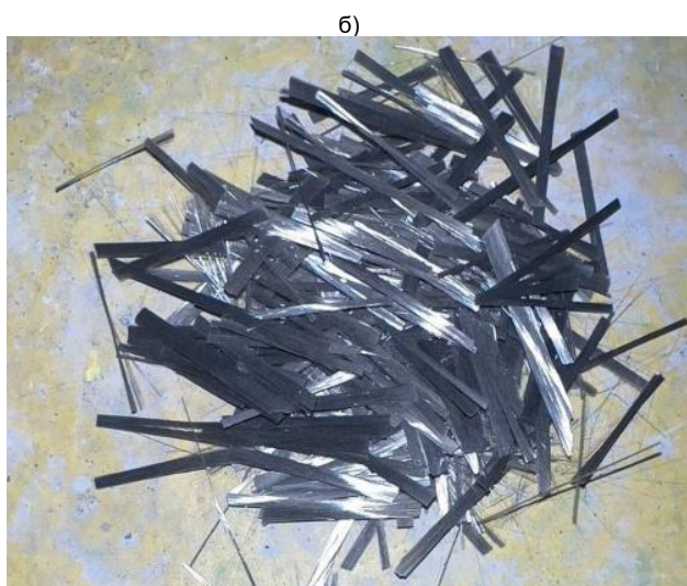
2-рasm. Бетон таркибида базалт топаларининг текис тарқалиши(а) ва алоҳида ҳолатдаги кўриниши(б).
