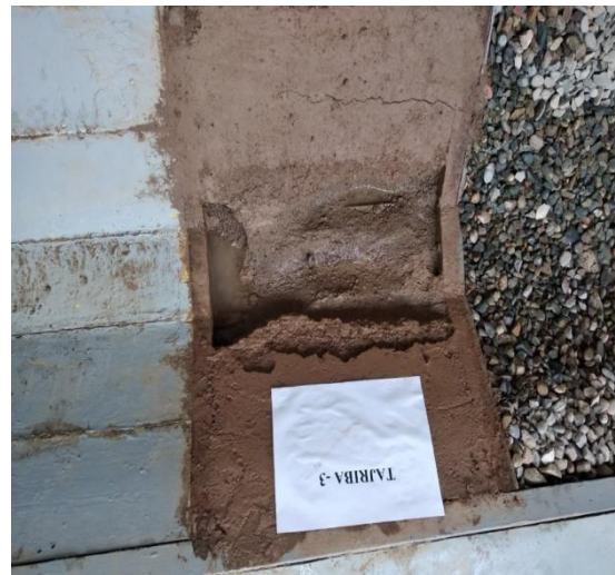
8-rasm. Vaqtga ko'ra bog'langan grunt eroziyasining o'zgarishi (transformatsiyasi) (3-tajriba)
