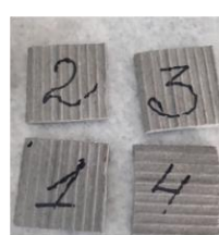
3-rasm. Bazalt sement asosida ishlab chiqarilgan tom qoplamasining o'rtacha zichligini aniqlash
