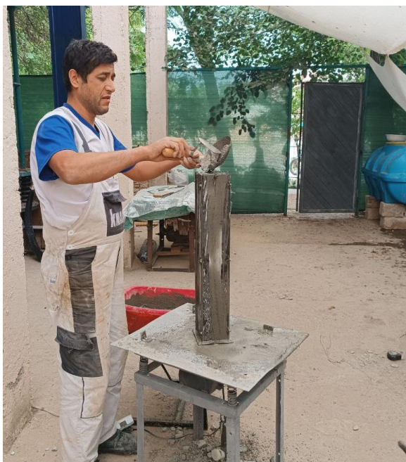
3-рasm. Устун namunalarni tayyorlash jarayoni
