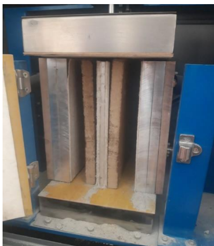
2-расм. (XND-2-3030C русимли машинада) вермикулит плита иссиқлик ўтказучанлик коэффициенти аниқлаш
