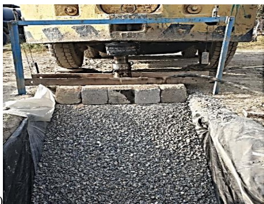
1-rasm. Shag'al qiyaliklarini sinovdan o'tkazish jarayoni. a- \alpha burchak bo'yicha, b- vertikal o'q bo'yicha
