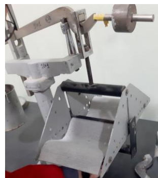
5-rasm. Bazalt sement asosida ishlab chiqarilgan tom qoplamasining egilishga bo'lgan mustahkamlik chegarasini aniqlash
