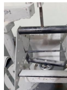
6-rasm. Bazalt sement asosida ishlab chiqarilgan tom qoplamasining egilishga bo'lgan mustahkamlik chegarasini aniqlash
