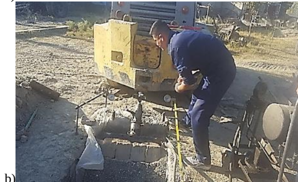
2-rasm. Yukning qiyalik bo'yicha vertikal ta'sir ettirish (a) va \alpha burchak ostida yuk ta'sir ettirish (b) jarayoni.
