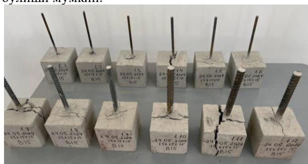
1-расм. Базалтфибробетон намуналарнинг бузилиш характерлари
