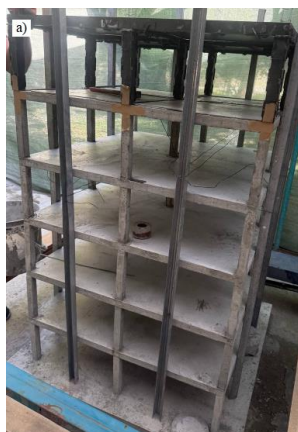
3- rasm. Bino modelining ko'rinishi: a) 6 qavatni barpo etish jarayoni; b) modelning to'liq ko'rinishi
