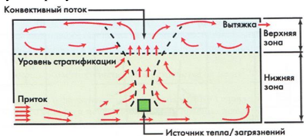
Рис.1. Принципиальная схема воздухораспределения потоков в помещении.
