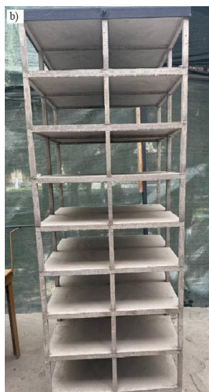
3- rasm. Bino modelining ko'rinishi: a) 6 qavatni barpo etish jarayoni; b) modelning to'liq ko'rinishi
