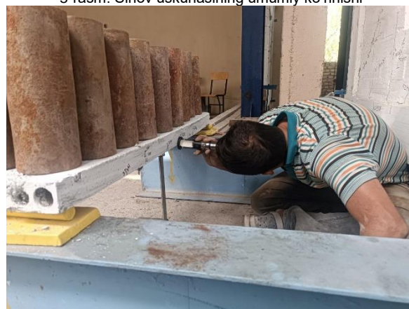
6-rasm. Yoriqlarni o'lchash jarayoni
