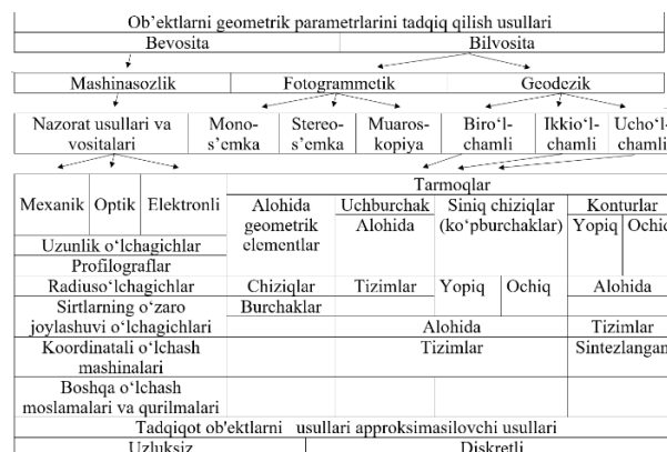
2-rasm. Obyektning geometrik xususiyatlarini tadqiq qilish usullarining blok-sxemasi
