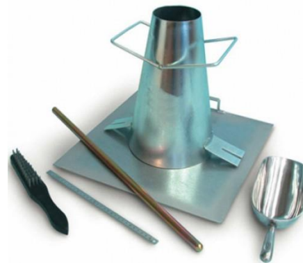
1.rasim. Kesik konus- harakatlanuvchanligini aniqlashda ishlatiladi, metaldan tashkil topgan o'lchamlari N=30sm, D1=20sm, D2=10sm.
